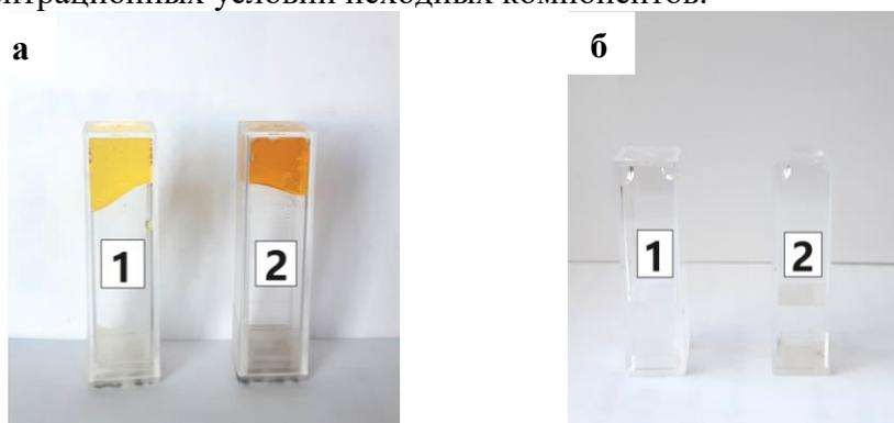
Рис. 2. Фотографии гелей на основе L-цистеина (а) и ЦСР на основе НАЦ (б) и  $\text{AgNO}_2$  при концентрации компонентов 0.025 М (а) при соотношении исходных компонентов 1.0/1.0 (1) и 1.0/1.25 (2)
