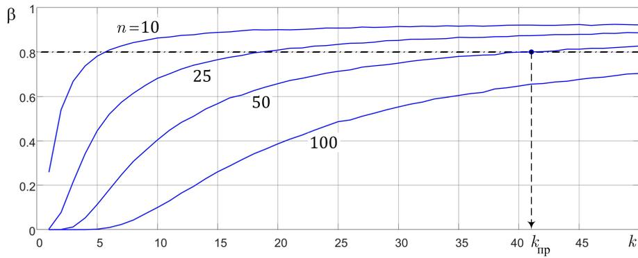
Рис. 7: Зависимость  $\beta(k)$  при использовании критерия Шапиро-Уилка
