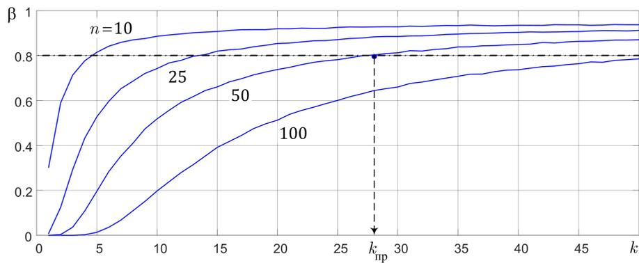
Рис. 9: Зависимость  $\beta(k)$  при использовании критерия Андерсона-Дарлинга
