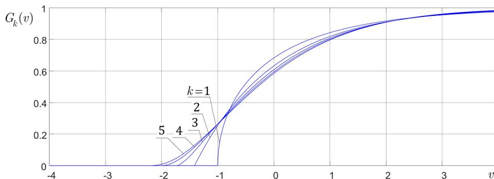
Рис. 3: Функции распределения нормированной случайной величины  $V_k$ , подчиняющейся закону хи-квадрат
