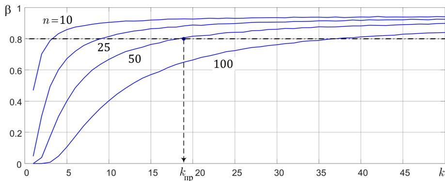
Рис. 10: Зависимость  $\beta(k)$  при использовании критерия Лиллиефорса
