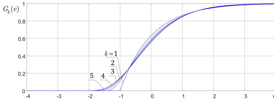
Рис. 2: Функции распределения нормированной случайной величины  $V_k$ , подчиняющейся закону Эрланга
