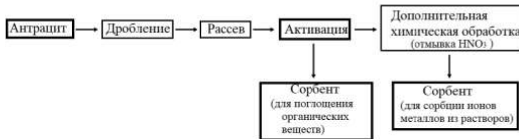
Рис. 1. Схема получения активированного угля из антрацита
