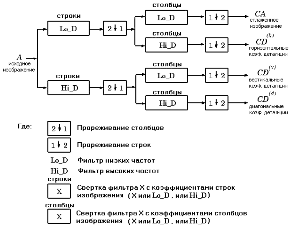
Рис. 5. Сглаживание и разложение изображения стереопары на коэффициенты детализации с помощью двумерного ДВП
