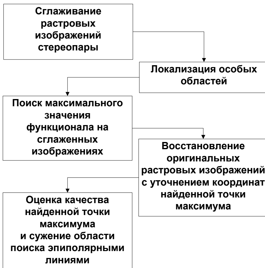
Рис. 4. Структурная схема алгоритма решения экстремальной задачи совмещения изображений
