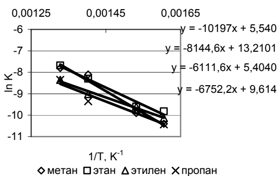
Рис. 16. Определение параметров уравнения Аррениуса для процесса без алюмосиликатов
