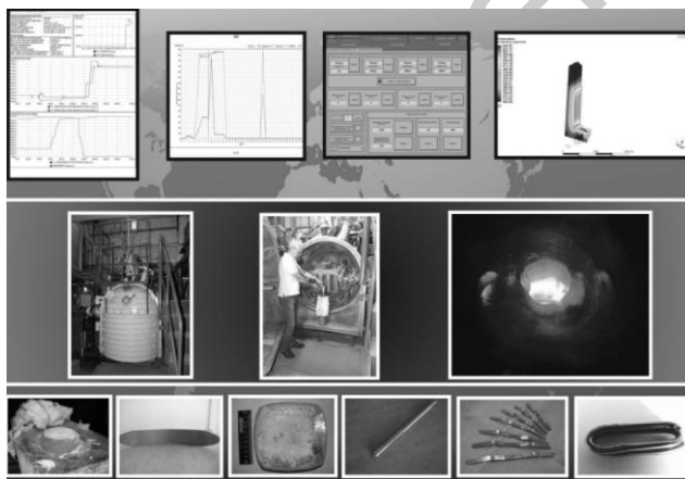
Рисунок 7 — Технология получения имплантатов из нитинола
