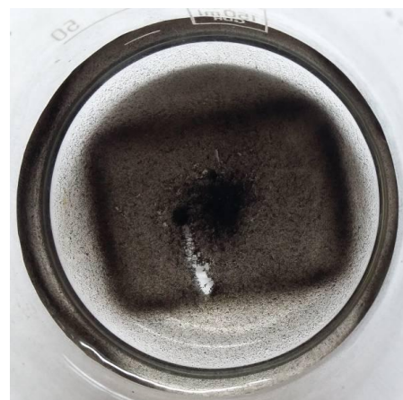
Рис. 3. Катализатор 5 % Ru-Fe 3 O 4 -SiO 2 после отделения от реакционной смеси внешним магнитным полем
