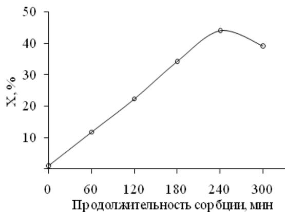
Р и с . 5. Влияние продолжительности реакции на степень превращения модифицированного волокна нитрон при обработке его полиэтиленполиамином. Температура реакции 373 К
