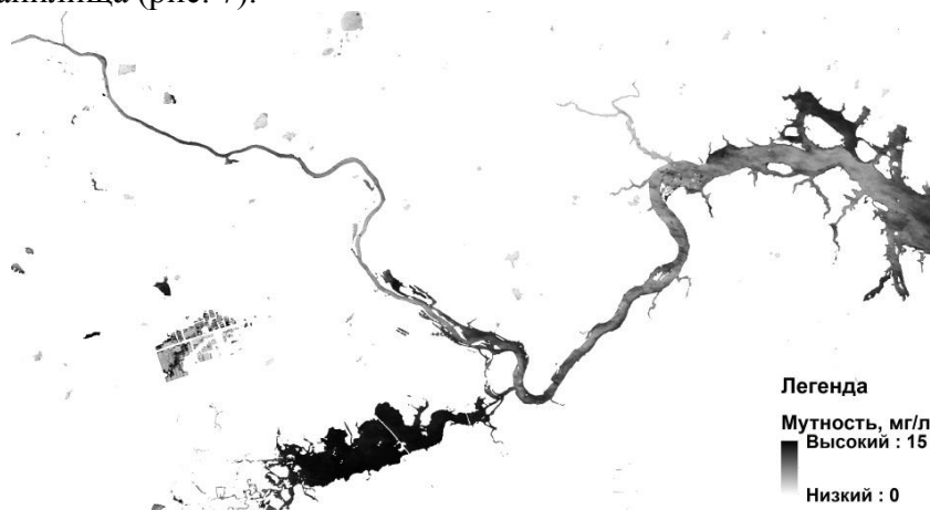
Рис. 7. Растр полученных значений показателя мутности воды Иваньковского водохранилища, по снимку Landsat-8 (4 июля 2015 г.)
