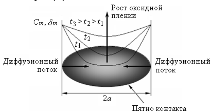
Р и с . 1. Схема роста поверхностной пленки на пятне контакта за счет диффузии окислителя
