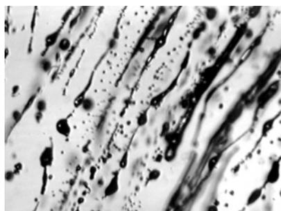
Рис. 3. Микрофотография пузырьковых треков в монокристалле парателлурифта
