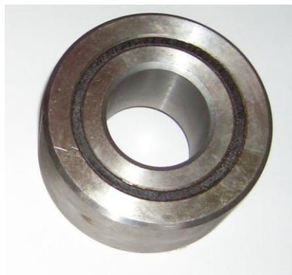
Р и с . 3 . Общий вид подшипника с вкладышем из модифицированного CVD-методом стеклопластика, изготовленного в условиях ремонтного производства с учетом замены в поворотной опоре ТСН-160А, ТСН-3Б двух серийных подшипников 60308
