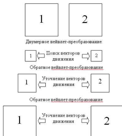
Рис. 2: Иерархическая схема поиска векторов движения
