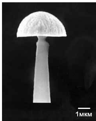
Рис. 1. Промежуточная стадия превращения вискера в острие
