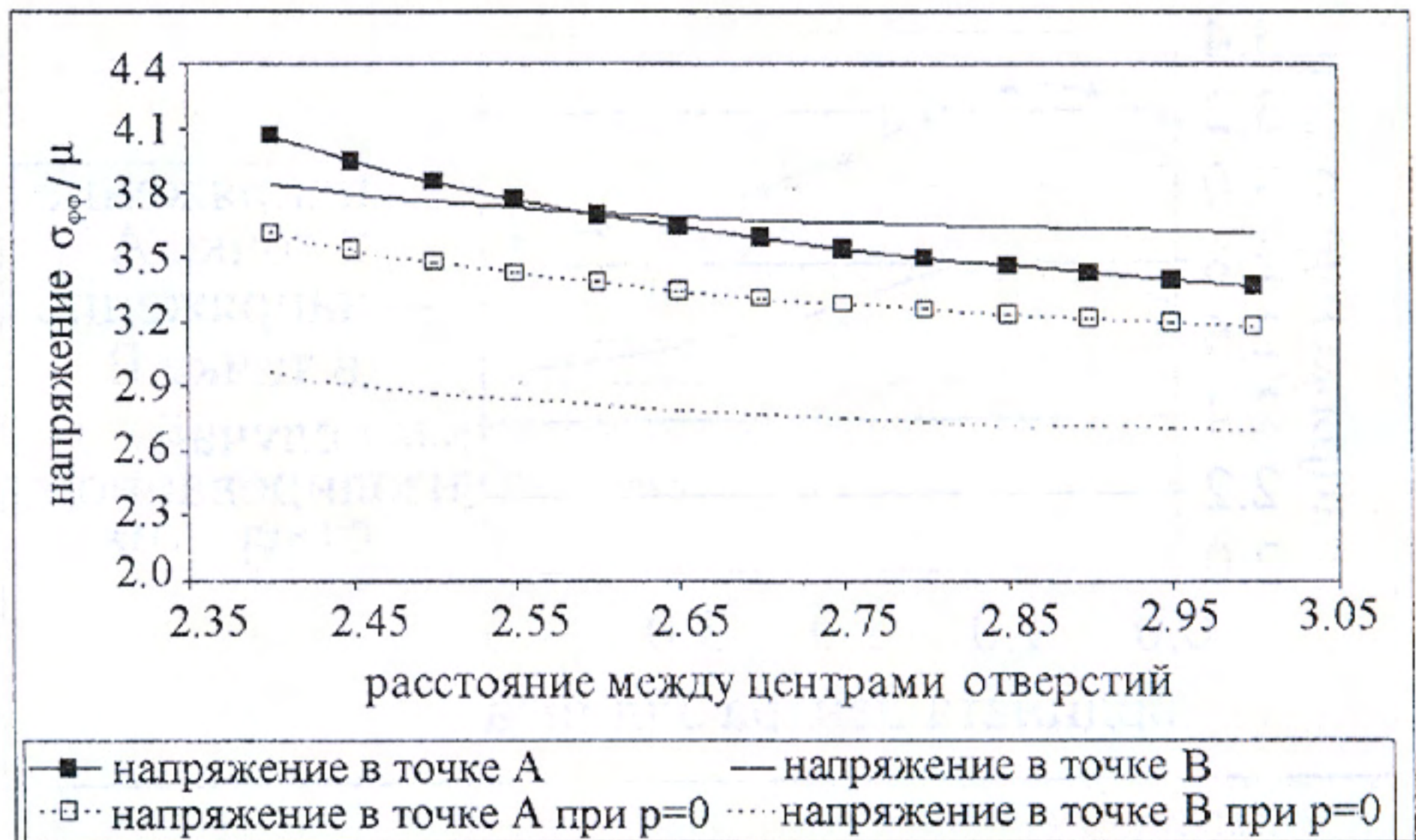
Рис. 4: Истинные контурные напряжения в точках максимальной концентрации при наличии давления и при его отсутствии в зависимости между центрами
