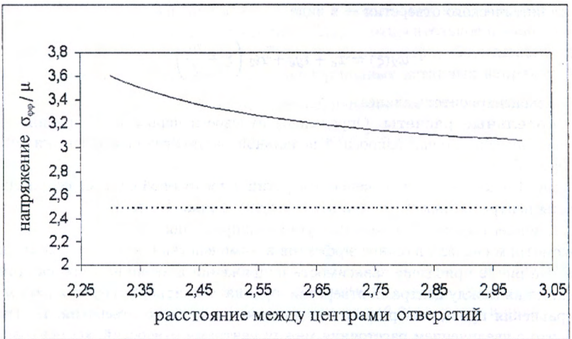
Рис. 2: Зависимость истинных контурных напряжений в вершине эллипса от расстояния между центрами отверстий (пунктирная линия соответствует изолированному отверстию)
