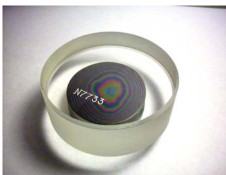
Рис. 1. Полированный образец №1 с пробным стеклом после ручной полировки на алмазных пастах
