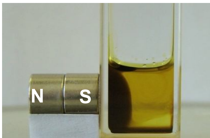
Рис. 8. Деформация формы поверхности парамагнитного слоя ИЖ в нитробензоле
