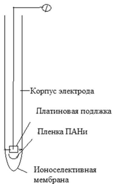
Р и с . 2. Твердотельный мембранный ионоселективный электрод с откликом на ион лидокаина
