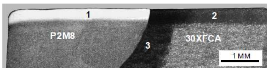
Рис. 1. Макроструктура наплавленной быстрорежущей стали
