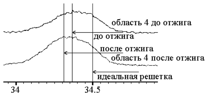
Рис. 8. Дифрактограмма монокристалла германия; область 4, пик (111)
