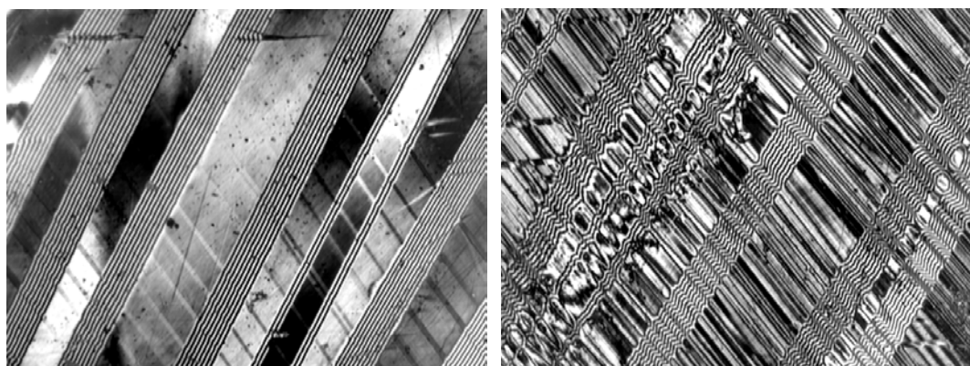
Рис. 3. Интерференционная картина полисинтетических двойников первого и второго порядка на плоскости (110) монокристалла \text{Co}_{48}\text{Ni}_{22}\text{Ga}_{30} . \times 140
