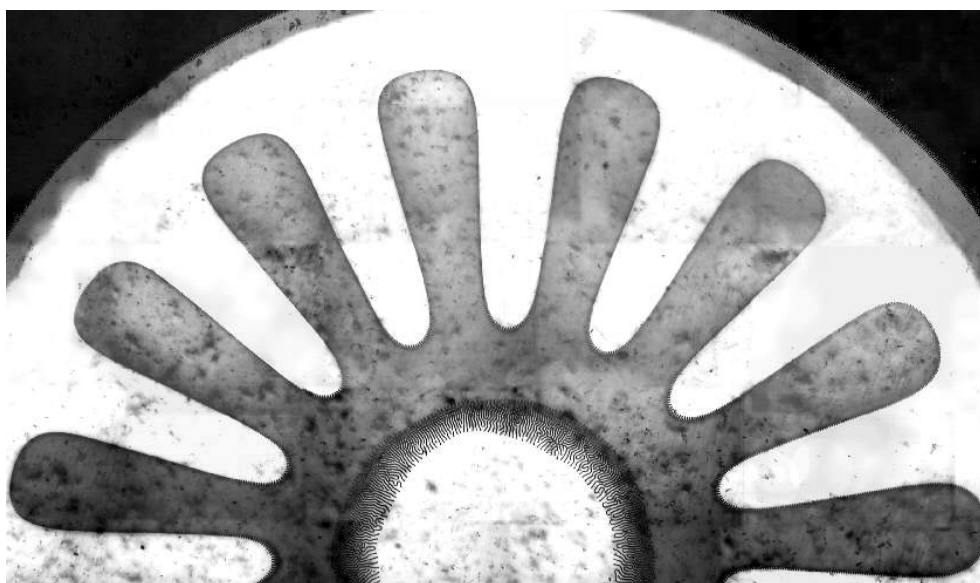
Рис. 2. Визуализация рабочего поля ротора (внешний диаметр 8 мм) с помощью одноосной индикаторной плёнки на расстоянии 50 мкм от поверхности
