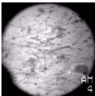
Рис. 4. Картина, наблюдаемая на кристалле \text{LiNbO}_3 + 0,1 \text{ ат. \% Mn} (X-срез) после травления. Поле зрения 0,02 \times 0,02 см
