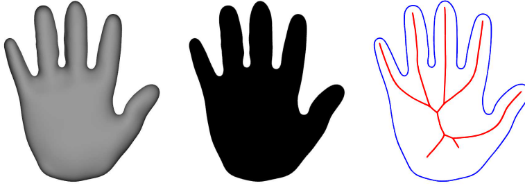
Рис. 2: Проекция объекта, силуэт проекции и середина ось силуэта
