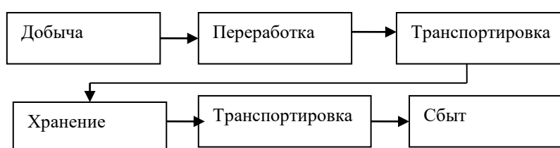
Р и с . 2. Взаимосвязь основных технологических процессов газовой отрасли
