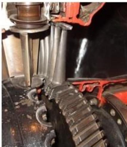
Р и с . 1. Фрагмент лопаточного аппарата газотурбинного двигателя ГТД-1250
