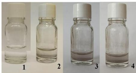
Рис. 1. Фото образца ГСР до облучения (1) и после УФ облучения в течение 1 часа (2), 1 часа 30 минут (3), 2 часов (4)
