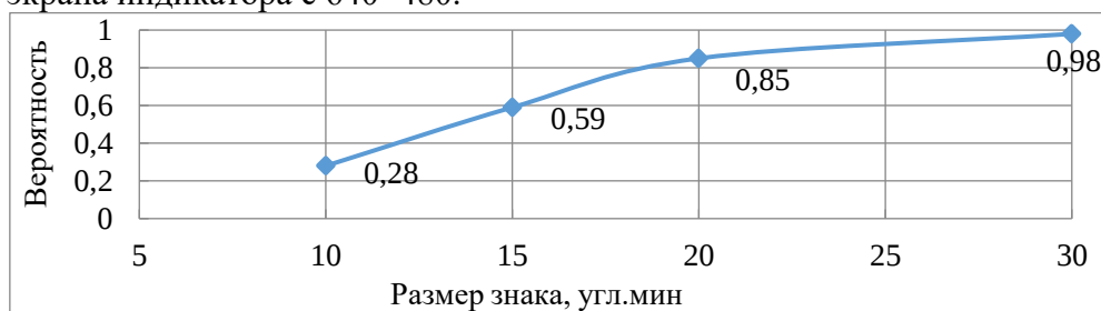
Рис. 1. Вероятность безошибочного опознания знаков, в зависимости от их угловых размеров
