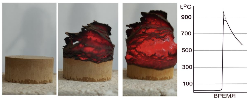
Р и с . 4. Развитие самораспространяющейся реакции и температура в системе \text{Bi}_2(\text{SO}_4)_3 - \text{Fe}_2(\text{SO}_4)_3 - 6\text{Na}_2\text{O}_2
