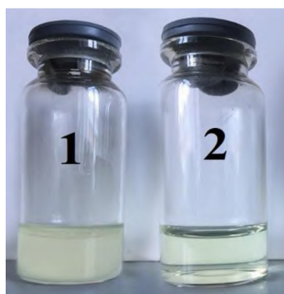
Рис.1. Иллюстрация процесса «созревания» ЦСР: 1 – через 1 мин после смешивания, 2 – через 280 мин нахождения раствора в состоянии покоя при T=25^\circ\text{C} .
